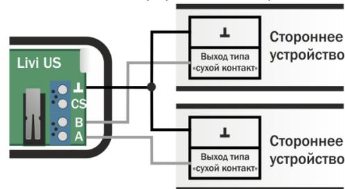
Схема подключения 1 устройства к датчику:
