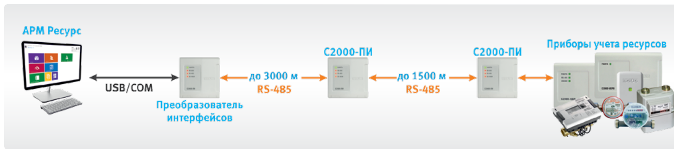
Схема подключения приборов по интерфейсу RS-485
