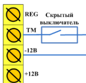
Рис. 4.6. Схема подключения скрытого выключателя или кнопки
