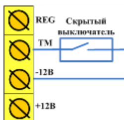
Рис. 4.6. Схема подключения скрытого выключателя
