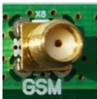
Рис. 4.3. SMA-разъем для подключения GSM-антенны
